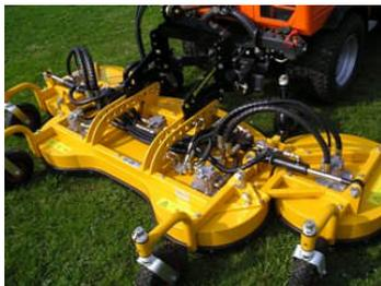
Die Modelle TH 2500-3000 sind vollhydraulische Sichelmäher, beide sind mit 5 Motoren ausgestattet. Der Hydraulikmotor ist direkt auf der Messerwelle montiert, daher kein Keilriemenverschleiß.
