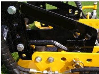
Der Montagerahmen am Mäher erleichtert schnellen An- und Abbau.
