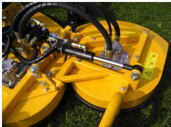
Der Triplex Mäher ist auf einen Rahmen gebaut. Das Mähdeck ist auf dem Rahmen angebolzt. Dies erhöht die Stabilität des Mähers und macht den Mäher robuster.
