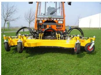
Mit Schwimmstellung passt sich der Mäher den Konturen der Landschaft an. Damit wird optimale Boden Anpassung mit Schnittbild gesichert.
