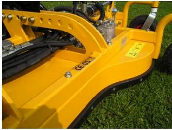
Auf der Unterkante des Mähdecks sind Stoßdämpfende, verschleißfeste PEHD 1000-Leisten montiert. Die Leisten sind auswechselbar.
