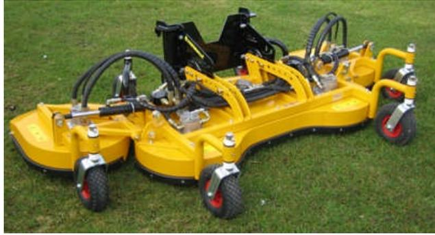
Den neuen Triplex Sichelmäher gibt es als mechanisch/hydraulische Version oder auch als Vollhydraulische Version. Erstmals werden diese in der Breite 2,5 Mtr. oder 3 Mtr. angeboten. Untenstehend finden Sie die technischen Details von den neuen Sichelmähern.
