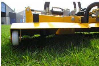
Der neue Triplex Mäher hat entgegen gesetzte rotierende Messer. (2 Stück linksdrehend und 3 Stück rechtsdrehend). Hierdurch wird eine bessere Grasverteilung und ein besseres Schnittbild erzeugt.
